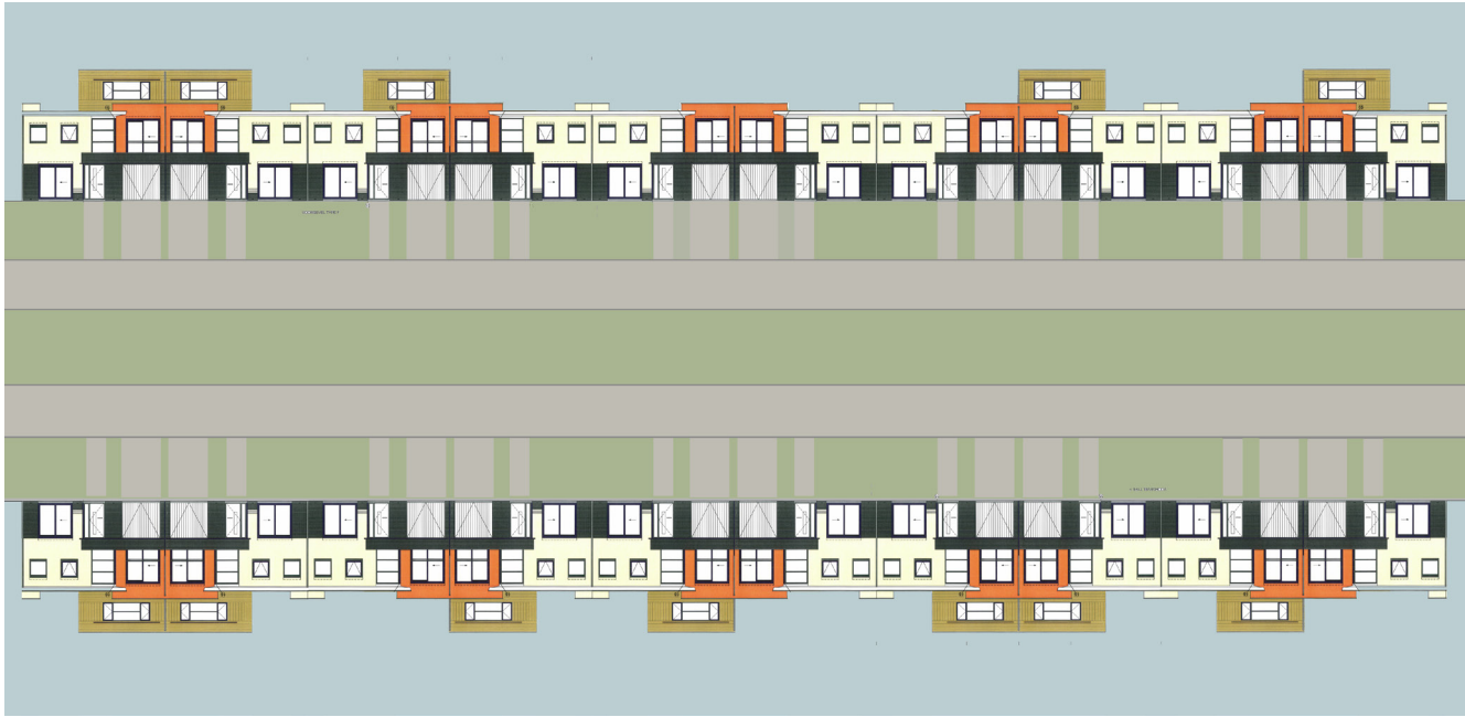
De dakopbouwen in de beoogde fasering uitgevoerd vormen geen samenhangend geheel en verrommelen de dakcontour.
